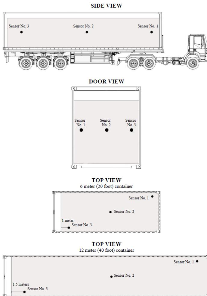
α) Δύο αισθητήρες θερμοκρασίας της σάρκας του καρπού τοποθετούνται σε κιβώτια που βρίσκονται διαγώνια αντίθετα στα πλευρικά τοιχώματα του εμπορευματοκιβωτίου και περίπου 1.5 μέτρο (για εμπορευματοκιβώτιο 40 ποδών) ή 1 μέτρο (για εμπορευματοκιβώτιο 20 ποδών) από την πόρτα.
